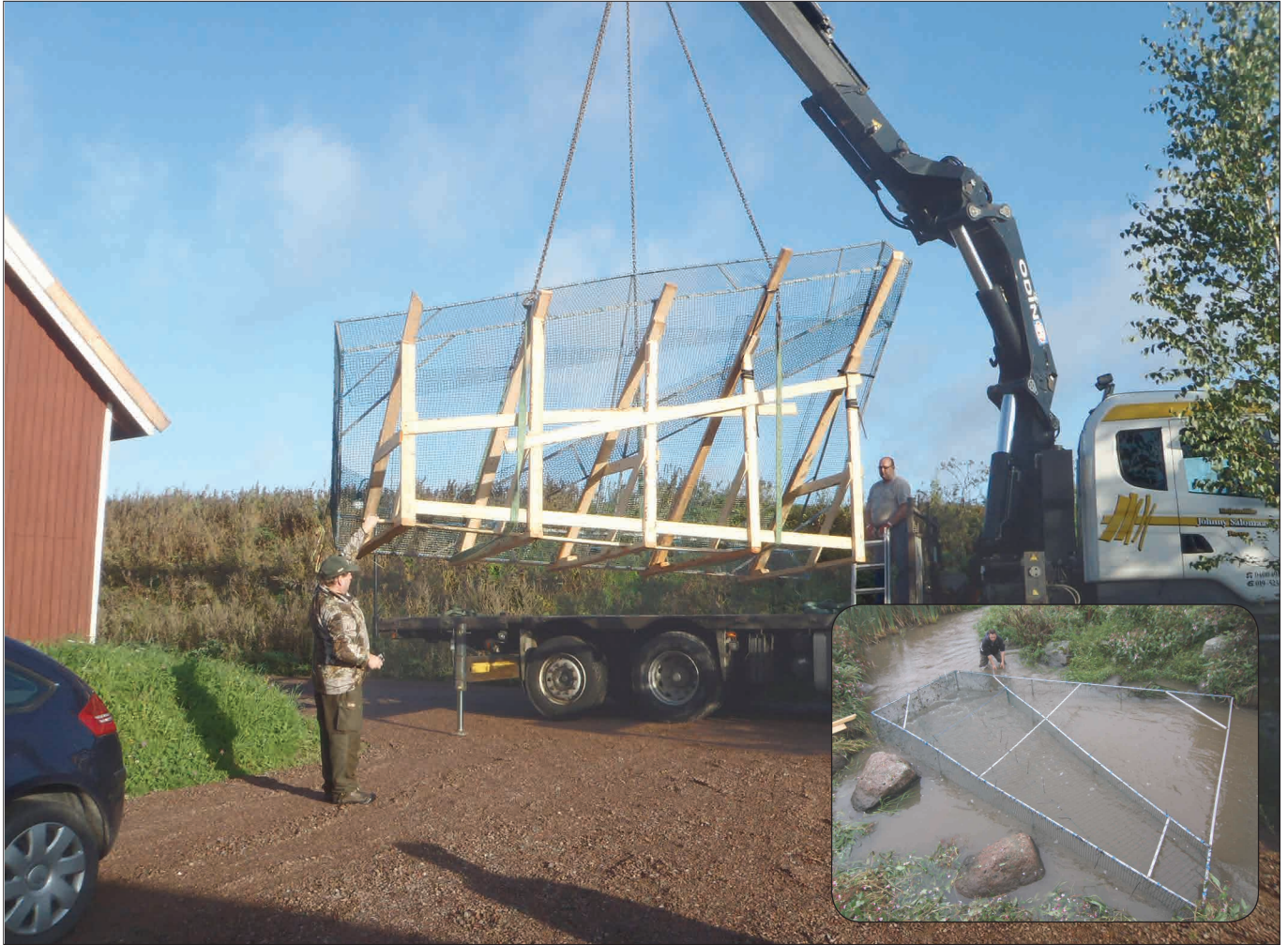
Kuva 10. Porvoonseudun kalastusalueen isännöitsijä Christian Lindén rakensi nimenomaisesti Strömsbergin kalatien tutkimiseen tarkoitetun rysäpyydyksen pajallaan. Neljä metriä leveä rysä kuljetettiin koskelle kokonaisuutena. Rysä asetettiin pyyntiin kalatien niskalle (upotettu kuva) siten, että kaikki kalatietä pitkin nousevat kalat uivat pyydykseen.
